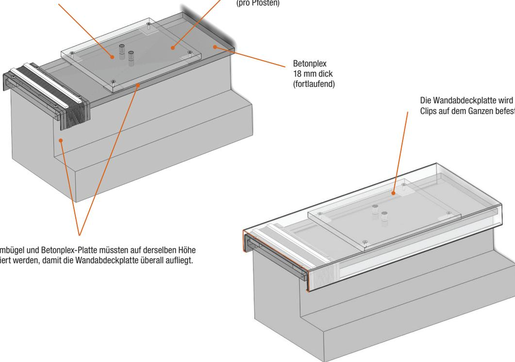
Klemmbügel und Betonplex-Platte müssten auf derselben Höhe montiert werden, damit die Wandabdeckplatte überall aufliegt.
