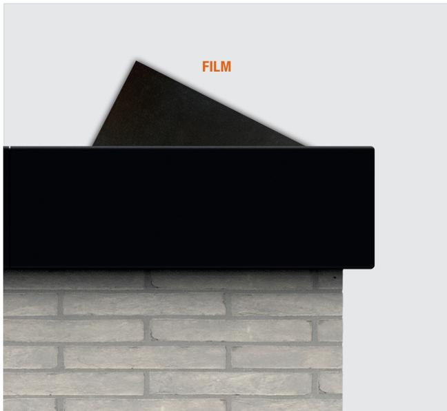
**Le système de rive Roofing Clips Fox se compose de 3 parties. Le profil de base est muni d'une pièce thermoplastique ABS qui permet d'encaisser les chevauchements de l'étanchéité synthétique jusqu'à 5mm. Le profil décoratif avec joint thermoplastique assure la fixation de l'étanchéité et permet de rendre la rive étanche à l'eau et au vent dans les couleurs souhaitées.**
